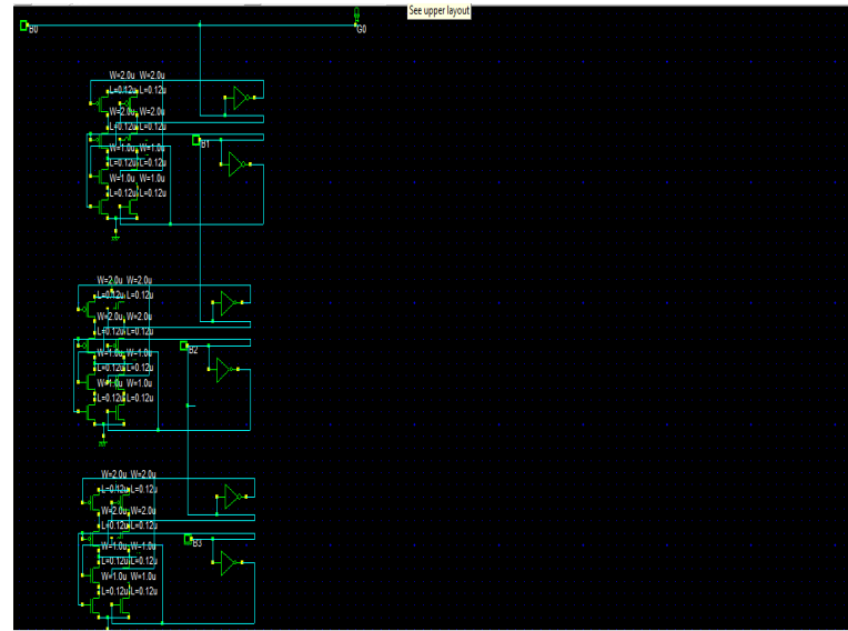
(d) Design of 8T XOR gate
