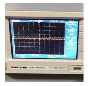
Fig 7. CRO OUTPUT OF EEG BRAIN WAVES
