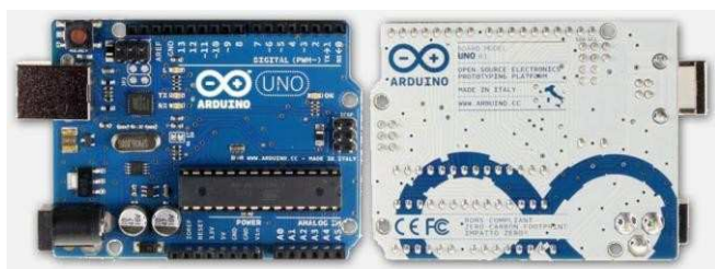
Fig 2: Arduino UNO microcontroller
